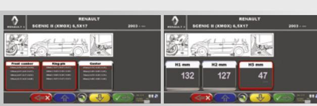
Dispositivo per rendere più rapida e precisa la misurazione dell'assetto. La banca dati modifica automaticamente le specifiche in funzione di altezza o inclinazione.
