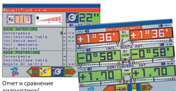
Отчет и сравнение диагностики/регулировки параметров на общем экране.
