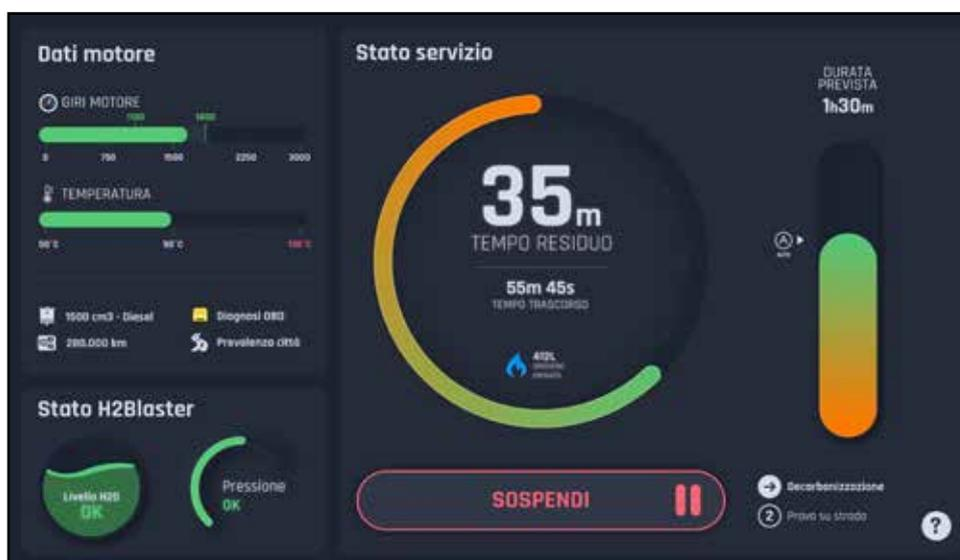
Пример фазы автоматического сервиса. Есть много полезной информации, в том числе прошедшее время, время, оставшееся до окончания очистки, литры водорода, а также параметры транспортного средства, установленные ранее.
