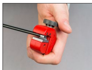
Позиционирование тормозной трубки для зачистки покрытия
