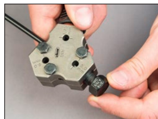
Процесс развальцовки согласно DIN
