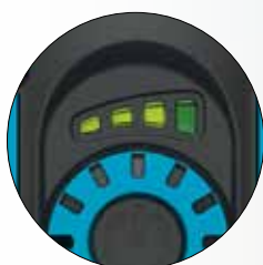
Индикатор 4-х состояний батареи и уровня зарядки, а также диммер на задней панели
