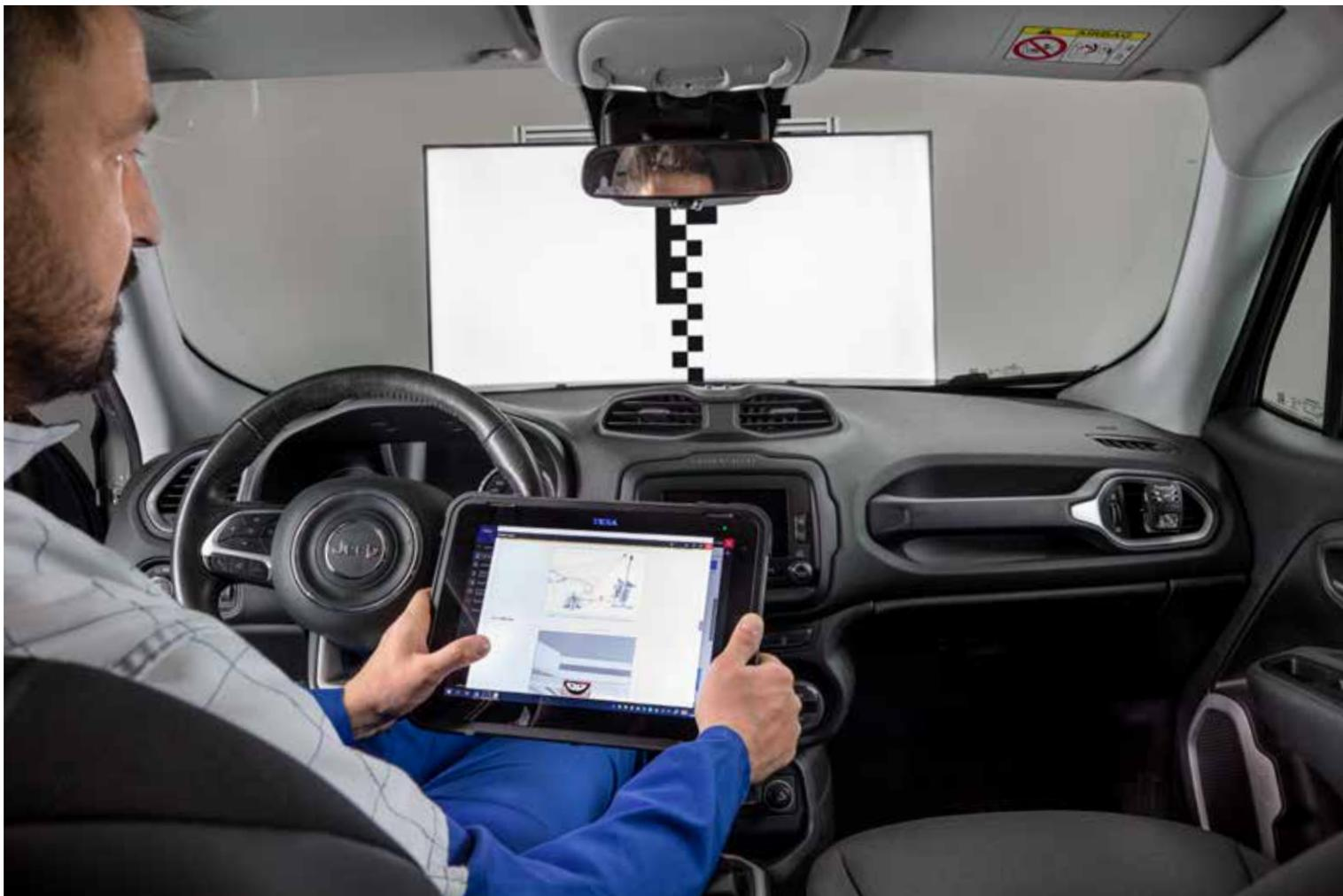
**Изображения** мишеней передаётся и **размещается автоматически** в зависимости от выбранного автомобиля. Их визуализация осуществляется с помощью линейного, безопасного и быстрого процесса.
