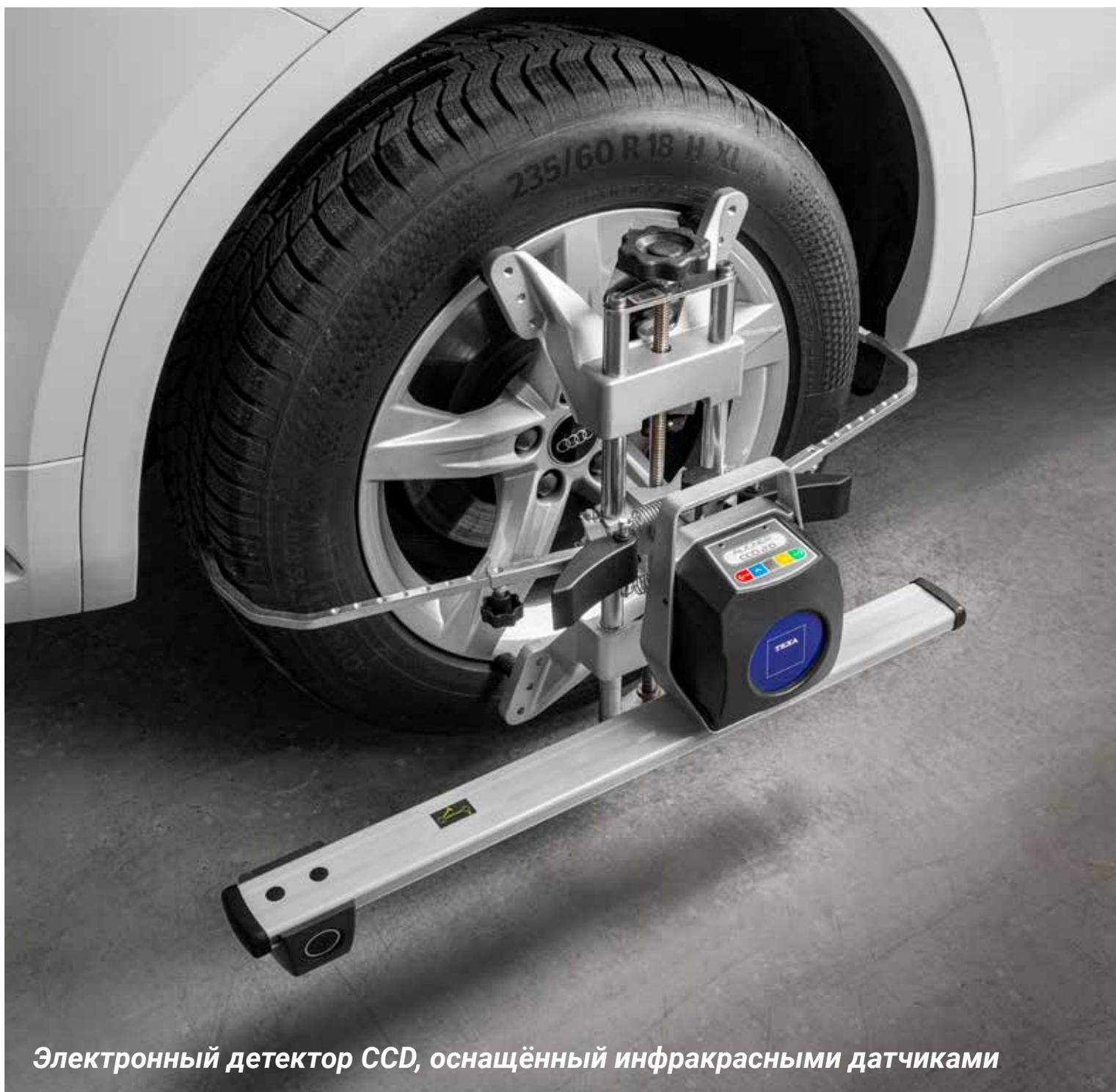
*Электронный детектор CCD, оснащённый инфракрасными датчиками*
