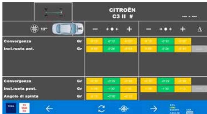
В фазе проверки угла установки колёс программное обеспечение позволяет установить диаметр колёс и показывает номинальные диапазоны конвергенции, полу-конвергенции и угла тяги.
